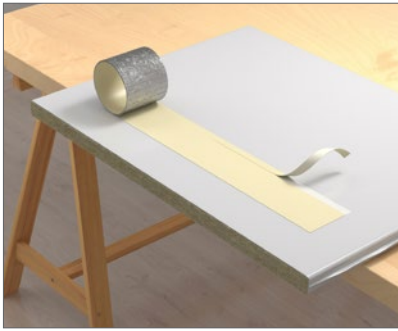
2. Mittaa leikatun reunan pituus + 10 mm ja ota suojapaperi kapealta osalta pois.
